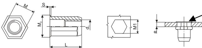
Loch-Ø eines aufzuschraubenden Bauteils muß immer direkt auf dem Kopf der Blindnietmutter aufliegen.
