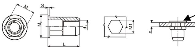
Loch-Ø eines aufzuschraubenden Bauteils muß immer direkt auf dem Kopf der Blindnietmutter aufliegen.
